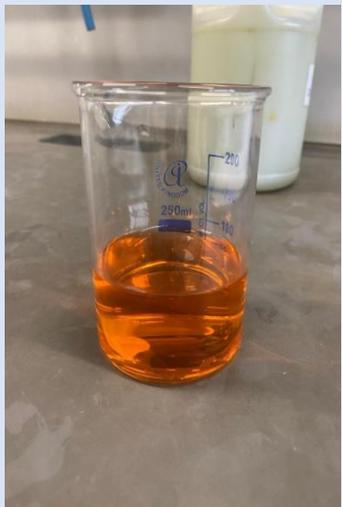
*Campione d'acqua da analizzare con aggiunta del titolante HCl (con indicatore metilarancio),*
